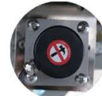
行走编码器 Spreading encoder
