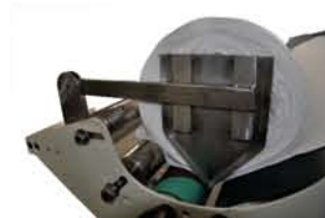
自动对齐布边 Automatic selvage alignment
